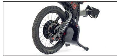
Neumático ultra adherente de 18" x 2.40". Llanta de aluminio negra de doble pared.
