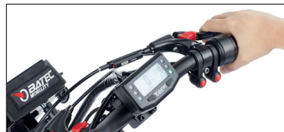
Disco de 180mm, dos frenos mecánicos, dos manetas de aluminio con freno de estacionamiento.
