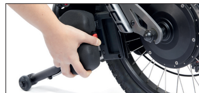
Lastres extraíbles QR para mejorar la tracción.
