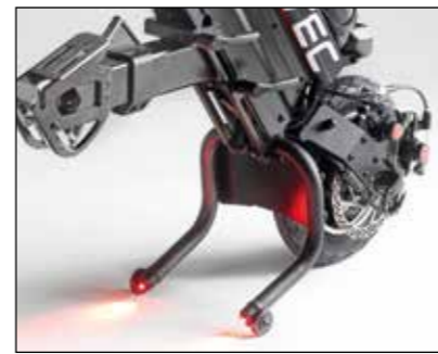
Caballote protector con ruedas y doble luz trasera de seguridad.
