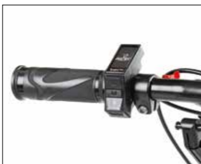
Pantalla color TFT, luces LED y botones.
